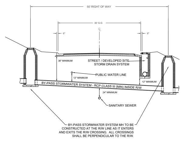
OFFSITE BY-PASS STORMWATER SYSTEM R/W CROSSING TYPICAL SECTION
